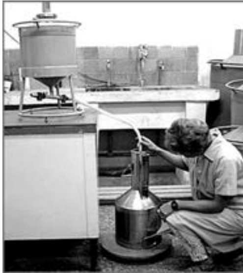
Fig. 6 Calibración de un patrón de volumen, por el método volumétrico.
